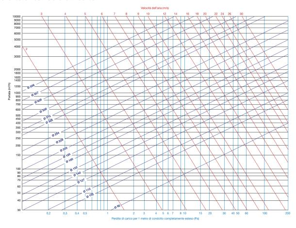
I dati di perdita di carico riportati nel diagramma soprastante sono validi per aria alla temperatura di 20° C. Per temperature diverse utilizzare i seguenti coefficienti correttivi:
